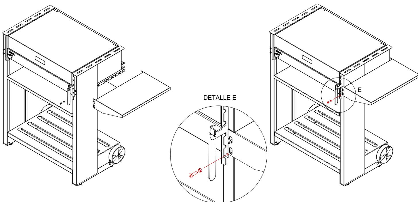
8.- Luego fijar la Bandeja Lateral usando los 2 Pernos cabeza plana M6x20, 2 bujes 3/8" x 4 en la cara posterior, como indica el detalle F.
