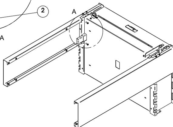
4.- Para montar el Pedestal, primero instalar los 4 Patines en la Base, como indica la imagen. Luego Posicionar el Pedestal entre los Paneles Laterales, y fijarlo con los 4 Pernos Parker M6x16.
