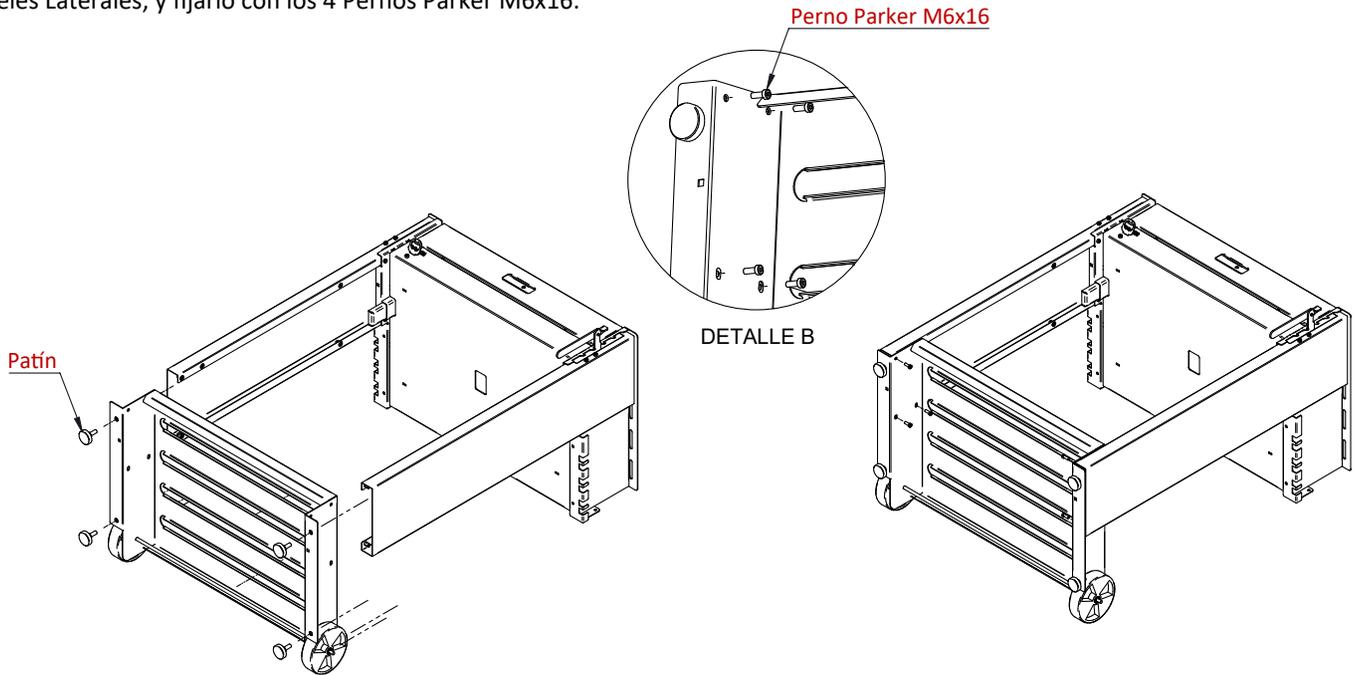
5.- Instalar la Bandeja Central entre los Paneles Laterales, como indica la secuencia, utilizando los 4 Pernos Parker M6x16. La Bandeja Central se puede instalar en 2 posiciones, con los bordes mirando hacia abajo, o hacia arriba.
