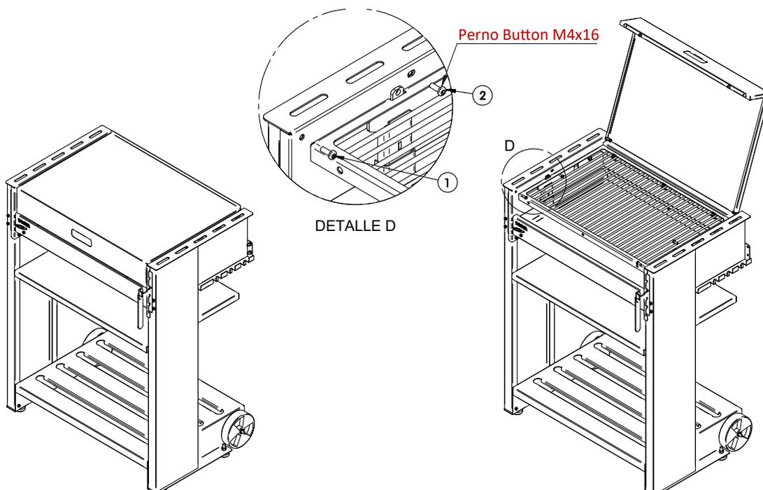
7.- Instalar la Bandeja Lateral calzando las perforaciones de la parte frontal de esta con los 2 Pernos y 2 bujes frontales previamente instalados en el Panel Lateral (ver detalle E).
