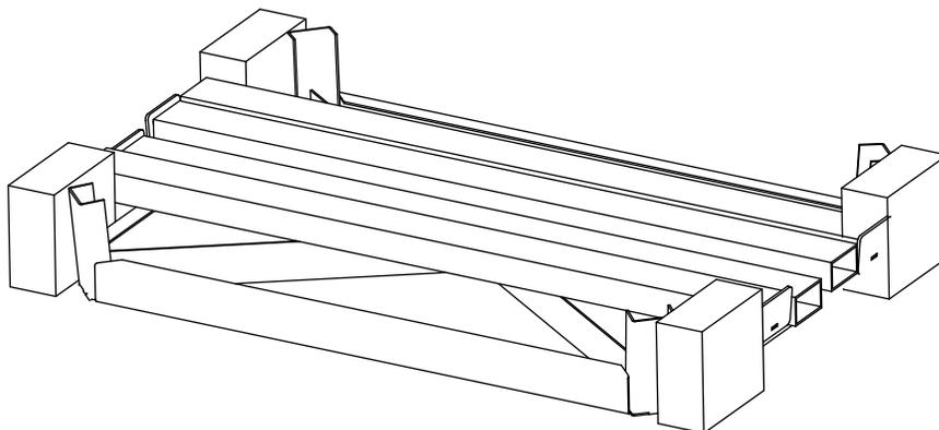
2. El extremo que va al suelo tiene una cara plana, el otro un calado para calzarlo con la base.
